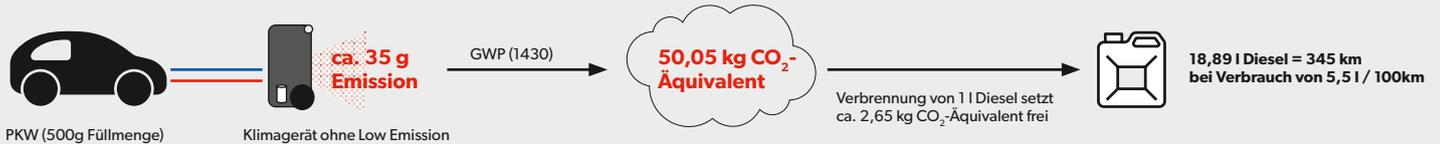
Der Klimaservice an einem durchschnittlichen Pkw (500 g Kältemittel Füllmenge) **ohne Low Emission** setzt ein CO<sub>2</sub>-Äquivalent frei, das mit der Verbrennung von circa 19 Litern Diesel vergleichbar ist.
