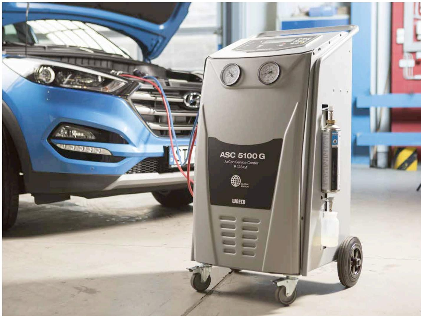
Sie steigen gerade ein in den Klimageservice an R 1234yf Klimaanlagen und haben aktuell nur wenige Serviceaufträge pro Monat? Dann haben wir hier ein preiswertes Servicegerät für Sie, das alle Qualitätsmerkmale mitbringt, die Sie für sicheres Arbeiten mit dem neuen Kältemittel benötigen: z. B. Lüfter für die gesetzlich vorgeschriebene Zwangsbelüftung. Die neue ASC 5100 G führt alle Serviceabläufe automatisch durch und erreicht dabei eine Kältemittel-Rückgewinnungsquote von mindestens 95 %. Die
