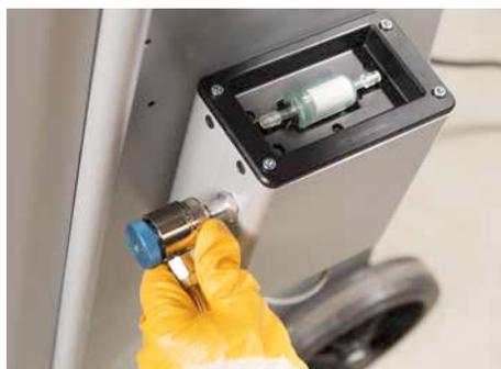
Gasanalysegerät nach SAE-Norm: Mit robustem Metallgehäuse und Gas-Sonde auf der Niederdruckseite
