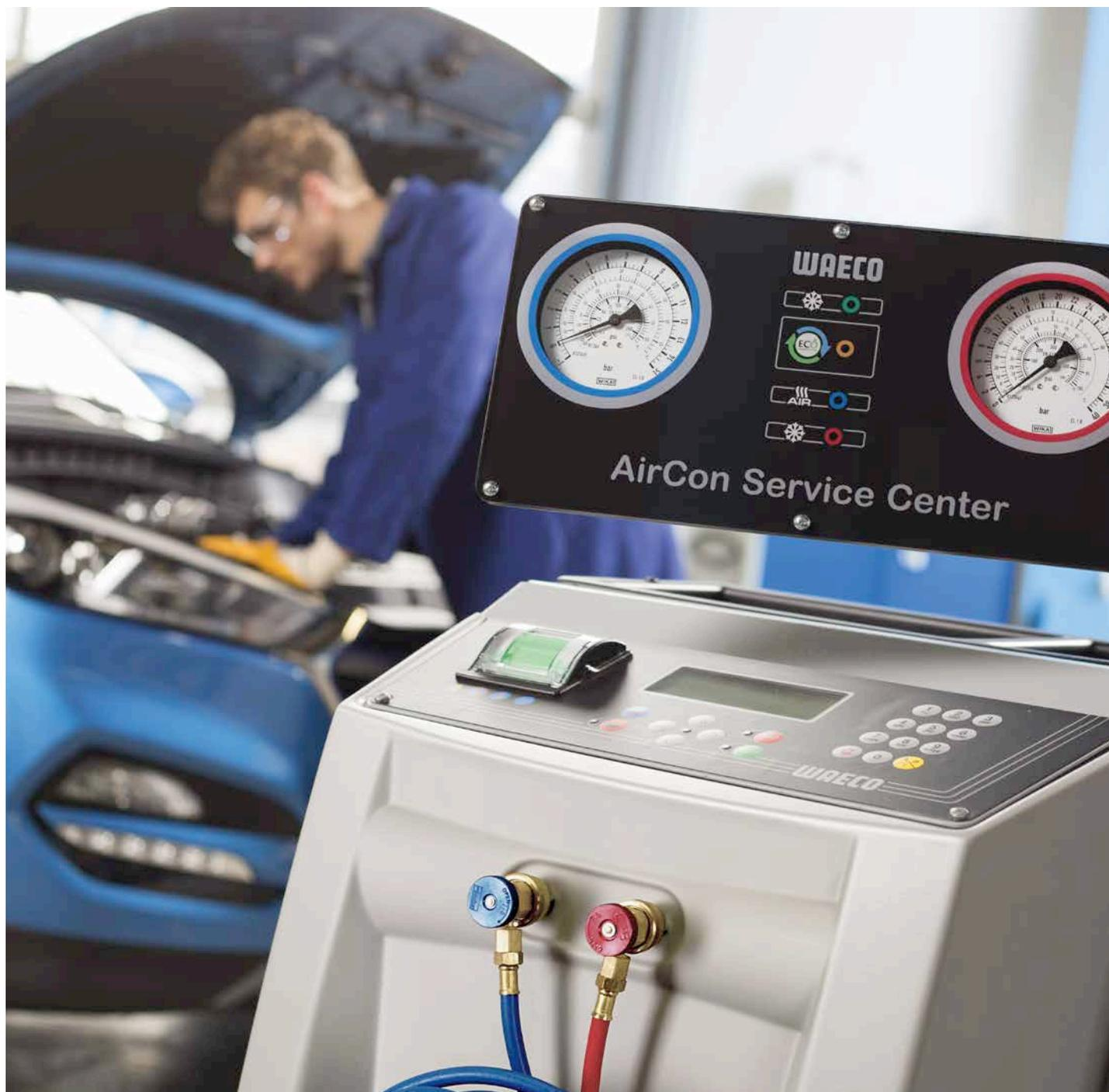
Bei dem ASC 2500 G Low Emission sind die wichtigsten Kältemittel führenden Komponenten auf der Wiegeplattform untergebracht. Auf diese Weise werden alle geräteinternen Kältemittelmengen erfasst; die Absaugmenge kann exakt bestimmt werden. Diese wiederum erlaubt dem Fachmann Rückschlüsse auf Undichtigkeiten an der Klimaanlage.
